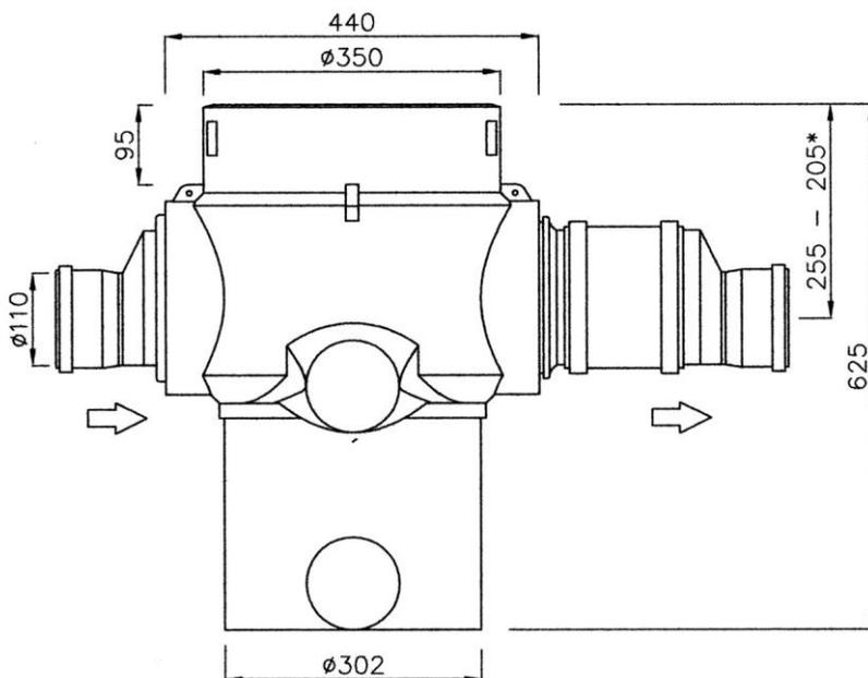
Der Anschluss an Leitungen DN110 erfolgt bauseits und kann mit handelsüblichen KG-Rohr realisiert werden (2 Reduzierungen; 1 Überschiebmuffe, siehe Zeichnung links).
