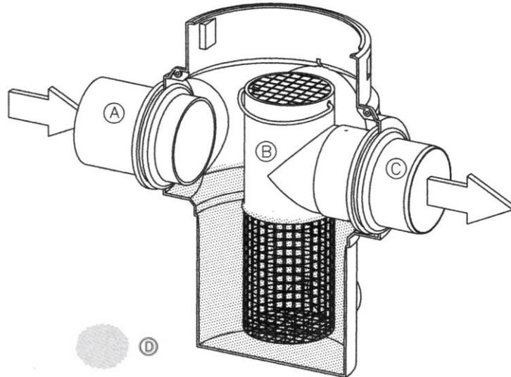
Das Regenwasser fließt durch den Zulauf (A) in das Filtergehäuse, dringt von außen durch die Maschen in die Filterpatrone (B, Maschenweite 1,1 mm) und fließt gereinigt durch den Ablauf (C) in die nachgeschaltete Anlage.
