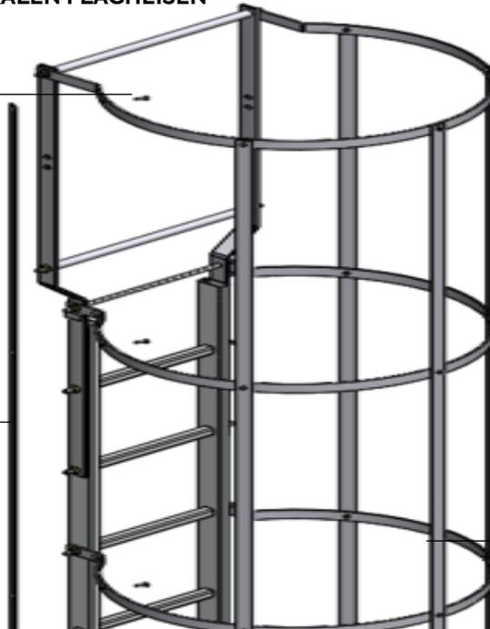
Vertikales Flacheisen mit Bohrung zur Verriegelung (x1)
