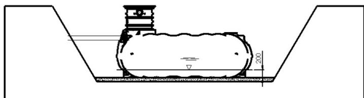
7. Setzen Sie die Umhüllung des Tanks mit Verfüllmaterial (Rundkornkies 8/16 mm) bis 100 mm über Tankschulter fort. Verdichten Sie das Verfüllmaterial wiederum.
